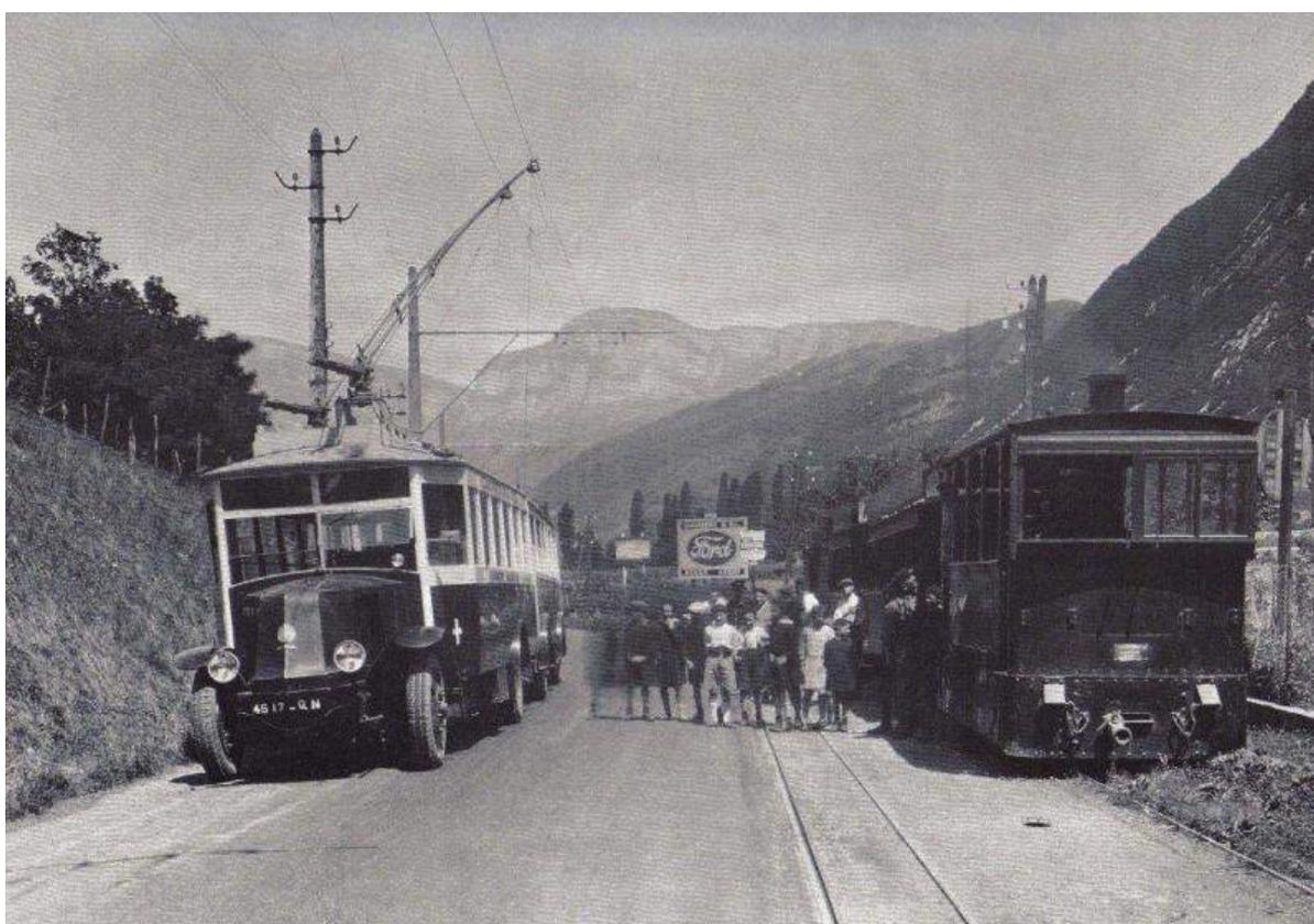
Changement d'époque à St. Jeoire Prieuré: à gauche le nouvel électrobus (bec de canard), à droite le tramway à vapeur lors de son dernier voyage. Sur cette photo on voit très bien que l'électrobus peut se déporter par rapport à l'axe de la ligne électrique, cela facilite les croisements.
