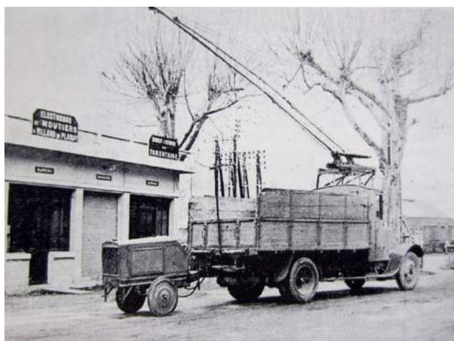
Camion "trolley" avec une remorque à accumulateurs, devant les bureaux de l'électrobus et du Syndicat d'Initiatives de Tarentaise, place de la gare.
